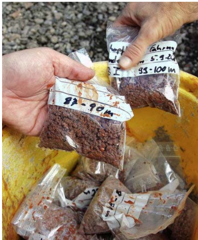
Tütchen mit entspannender Wirkung: Die Bohrproben bestehen wie erwartet aus Buntsandstein. Foto: André Hönig
